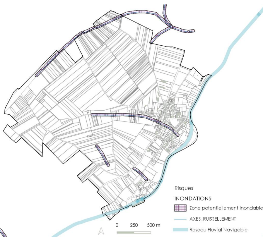
Figure 147 Risque d'inondations par ruissellement à Ramillies
