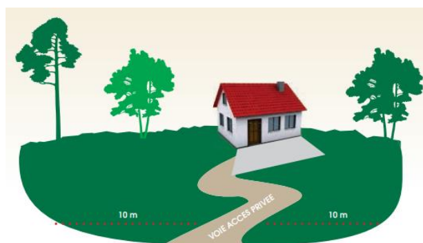
Figure 100 : Débroussaillage des voies d'accès
